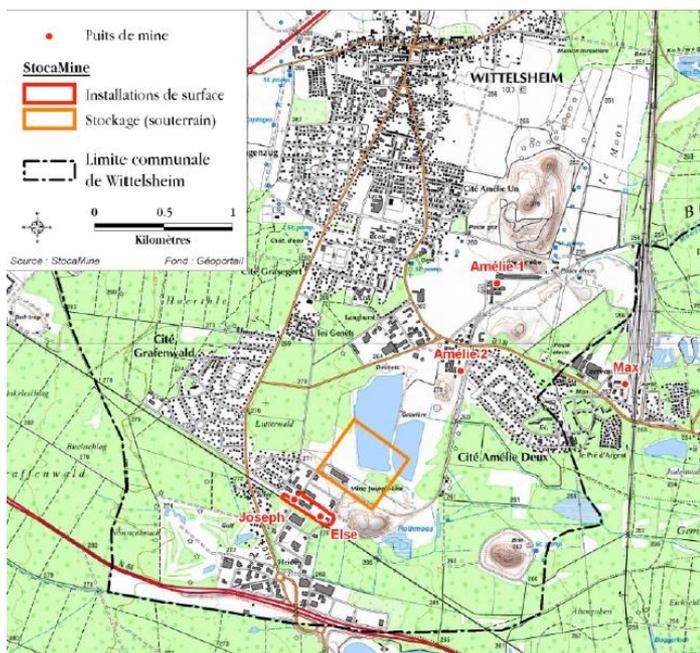
Localisation des installations de surface et du stockage souterrain de Stocamine
